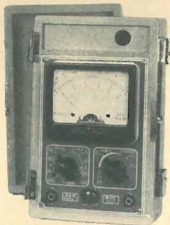
ANALIZZATORE Mod. 601/1 10.000 OHM/VOLT cc. e ca. 5 portate voltmetriche cc. e ca. da 10 a 1.000 Volt - 5 Milliampereometriche da 100 microamper a 500 miliamper cc. - Ohmetro in 3 scale da 1 ohm a 5 Megaohm
